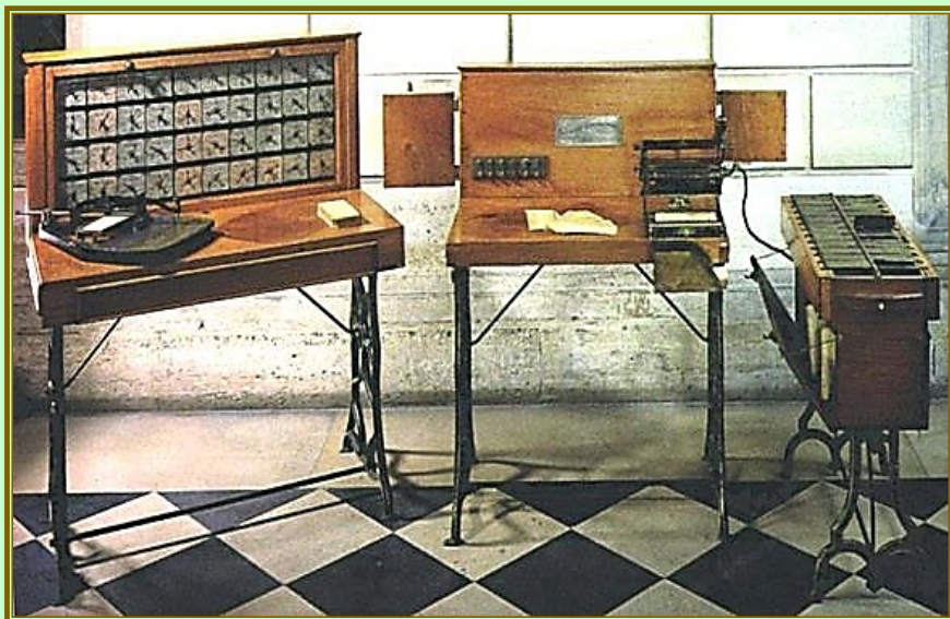
La machine d'HOLLERITH - 1889. On distingue nettement, à gauche, la perforatrice à pantographe et, sur la droite de la machine centrale, le lecteur de cartes.
