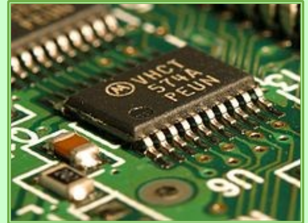
Circuit intégré sur un circuit imprimé
