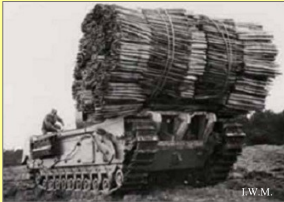
Le char « Fascine », assemblage en fagots de planches pour combler les fossés
