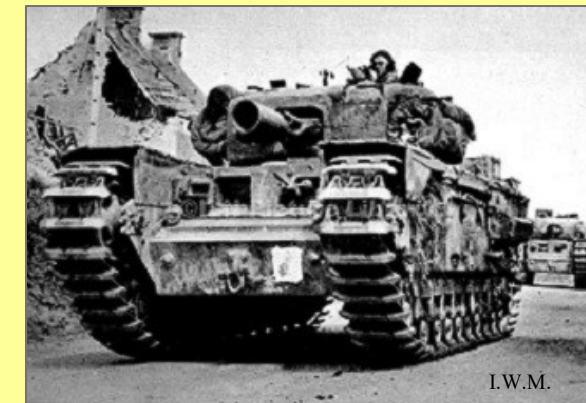
Le char « Avre », obusier de 290 mm, pour une destruction plus rapide des fortifications
