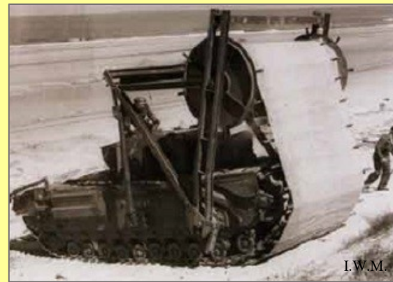
Le char « Bobbins », pour la pose de tapis souples ou de treillis
