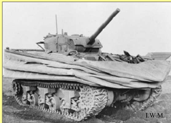
Le char « Duplex Drive (DD) » amphibie, ici avec sa jupe repliée
